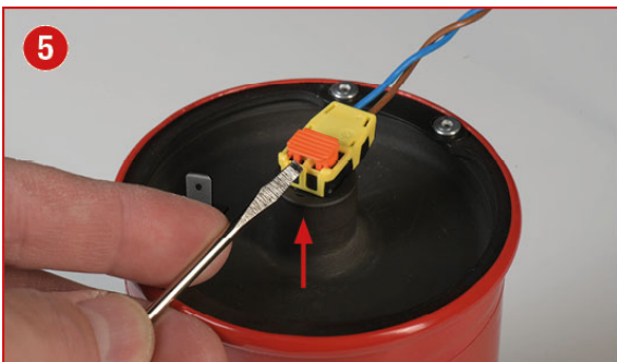
Anheben des orangenen Schiebers am Steckverbinder
