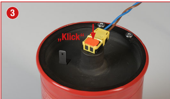
Verriegelung durch Herunterdrücken des orangenen Schiebers am Steckverbinder herstellen
