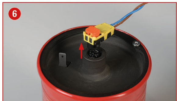
Steckverbinder von Dynameco-Kontakteinsatz lösen.
